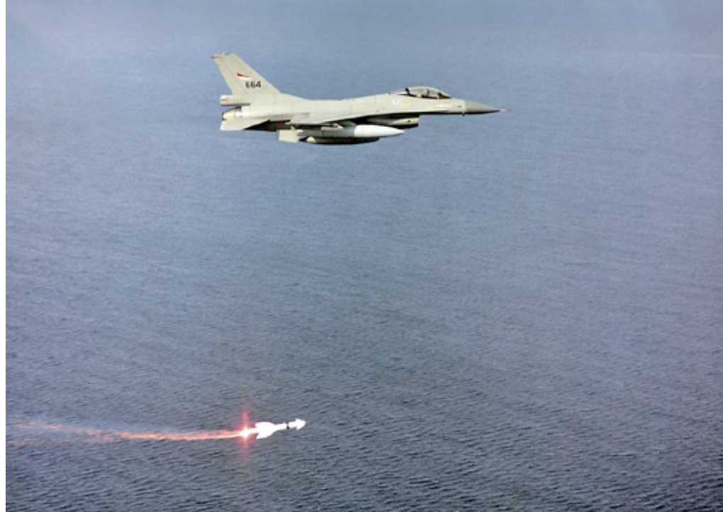
▲ Antisjønvasjonsrollen tok litt tid å få på plass. Kongsberggruppens Penguin Mk3 ble valgt. Den måtte både tilpasses datamessig på F-16 og sertifiseres til å bæres på to av flyets våpenstasjoner. Foto fra testing i Andfjorden 1 juni 1984. Foto: Luftforsvarsmuseet
