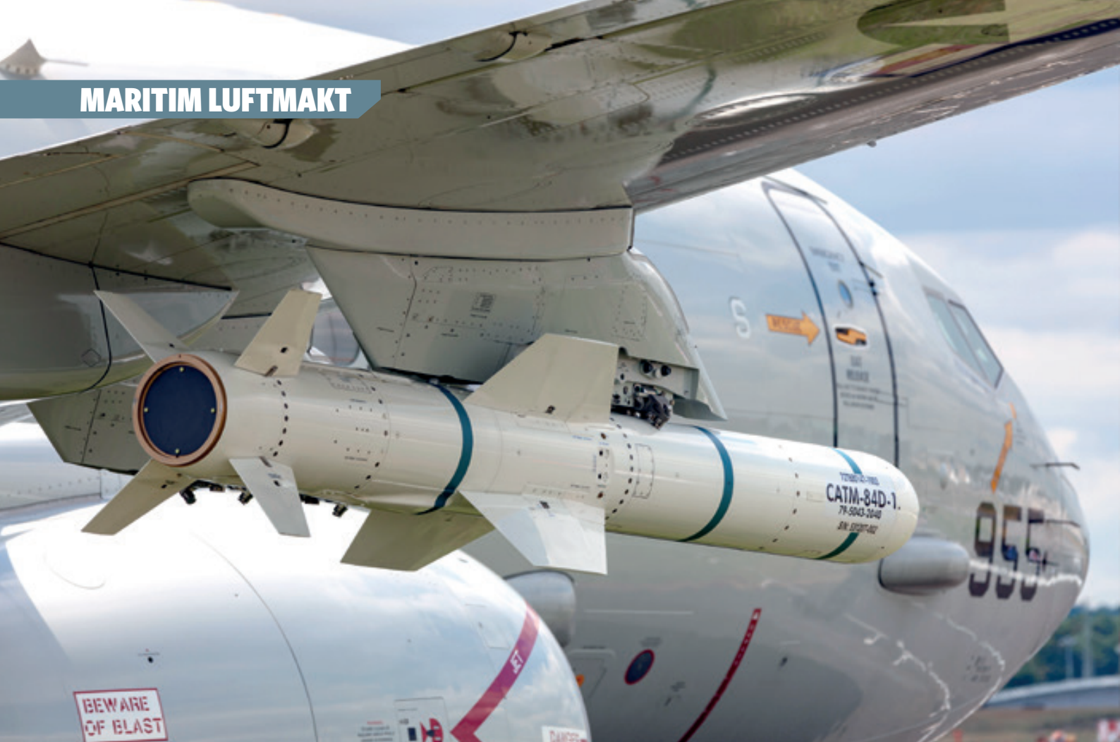
▲ Bevæpning av de maritime patruljeflyene med anti-overflate våpen vil gi en større fleksibilitet og større evne til å gjennomføre nektelse eller kontroll i det maritime domenet. Bildet viser P-8 med AGM-84 Harpoon Anti Ship Missile. Foto. Ryan Fletcher/Shutterstock
