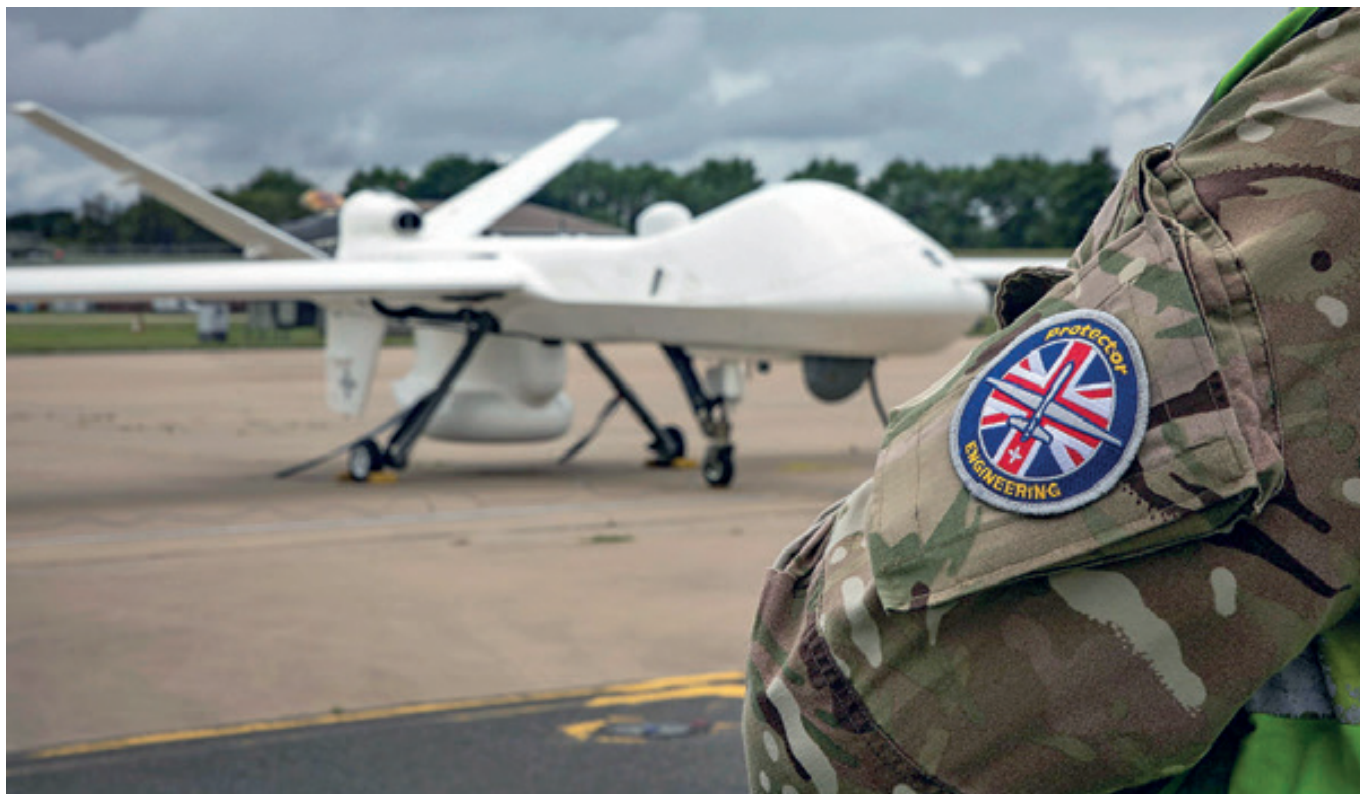
▲ Bildet viser en britisk Sky Guardian/Protector. Protector RG Mk 1 [MQ-9B] er etterfølgeren til Reaper [MQ-9A]. Protector er en såkalt MALE drone [Medium-Altitude, Long Endurance (MALE) aircraft]. Foto: UK MoD
