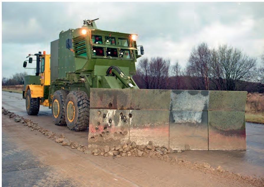
▲ Mineryddingskjøretøy som inngikk i Airfield Damage Repair-konseptet utviklet ved FFI.
