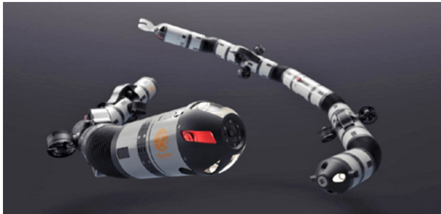
▲ Elumee-kjøretøyer er i utgangspunktet selvgående, autonome robotarmer hvis slanke og fleksible kropp kan passere over lange avstander og utføre oppgaver i trange rom som ikke er tilgjengelige for konvensjonelle undervannsfarkoster. Elumee er en virksomhet spunnet ut av NTNU. Illustrasjon: Elumee.com
