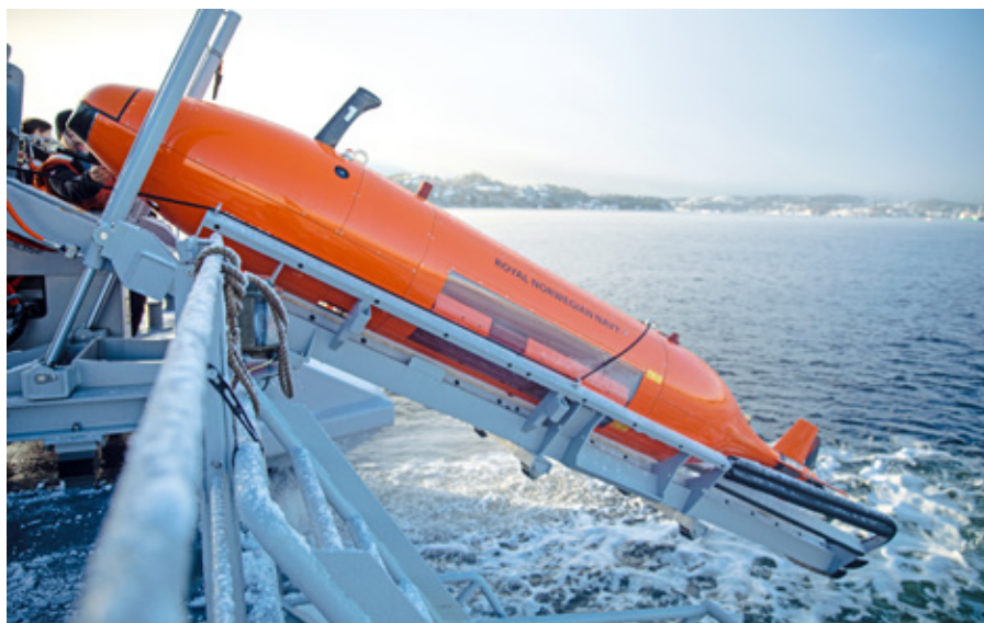
▲ FFI og Kongsberg Maritime AS utviklet Hugin – en autonom undervannsfarkost (AUV) som selv kan tilpasse operasjonsmønstret sitt for å oppfylle oppdragenes målsetninger best mulig. Dette gjør den ved å tolke data fra ulike sensorer og bruke denne kunnskapen til å analysere situasjonen rundt, planlegge og utføre handlinger. Bildet er fra øvelse FLOTEX 21. Foto: Forsvaret
